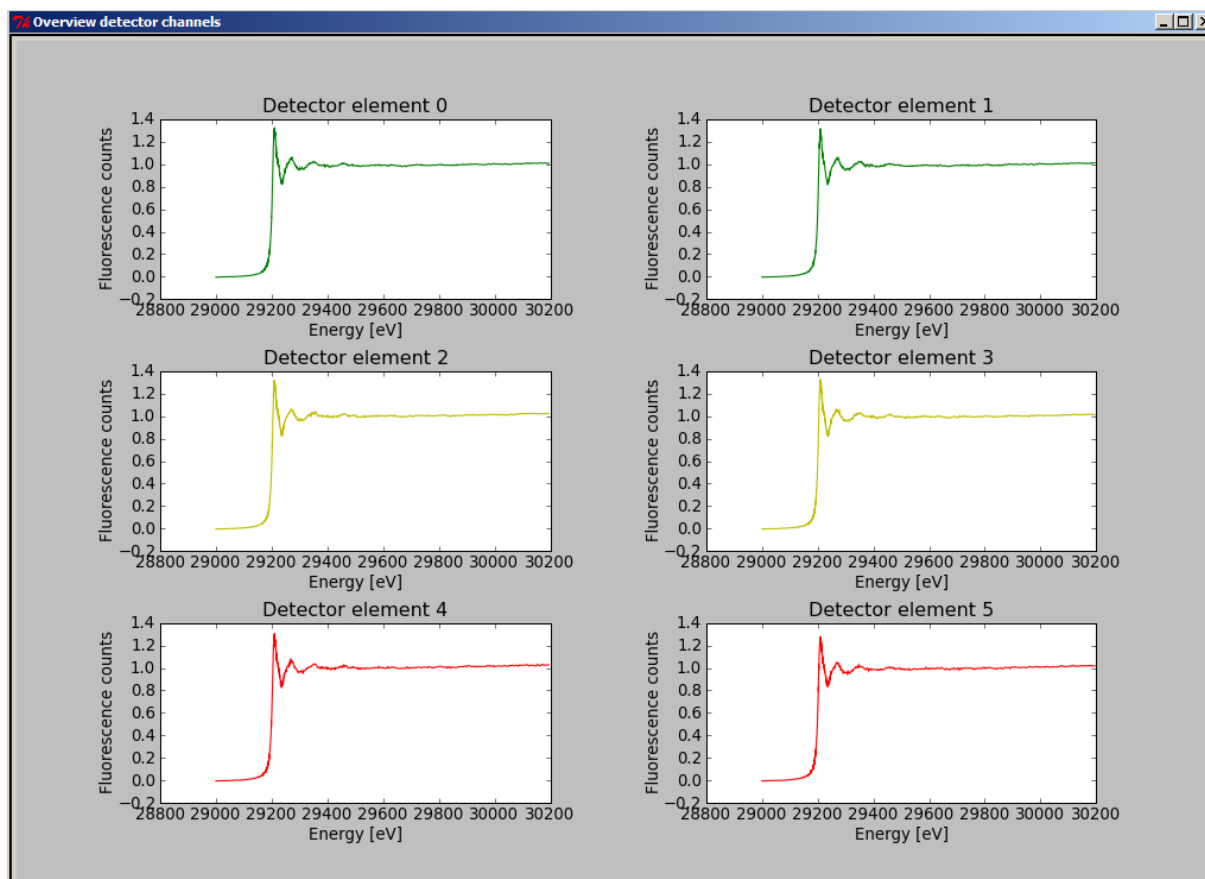
Fig.2 Overview detector channels: green spectra - parameter t_d < 0.1 , yellow spectra – parameter t_d < 0.3 , red spectra t_d > 0.3 .
