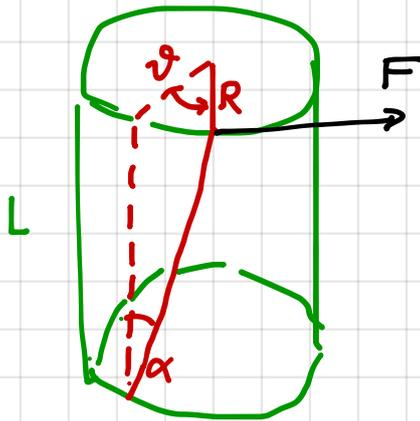
Verdrehung entspricht Scherung der einzelnen Elemente
