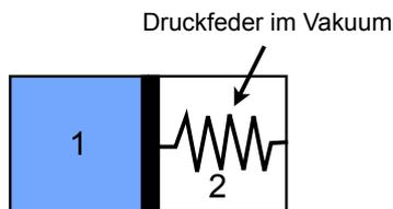
Die Erhöhung von  $U_1$  kann man auch im mikroskopischen Bild verstehen: bei der elastischen Reflexion der Gasatome am bewegten Kolben vergrößert sich die kinetische Energie der Atome.
